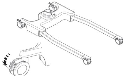
2. Stecken Sie die Mast/Ausleger-Baugruppe in die entsprechende Buchse des Rahmens.
