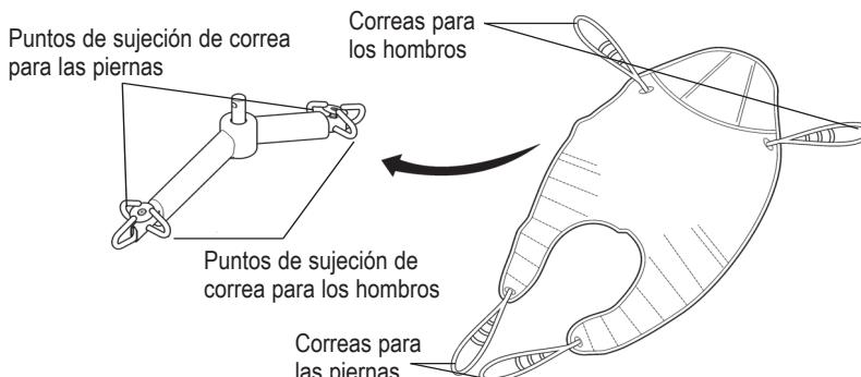
**Barra de extensión de 6 puntos:** ejemplo de la barra de extensión de 6 puntos con sujetaciones de bucle.
