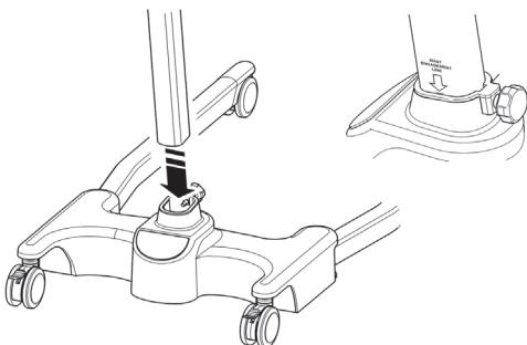
3. Resserrez le mât à l'aide du dispositif de verrouillage du mât situé devant le châssis.
