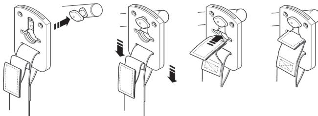
Système de fixation à sangle Securi3. Exemple d'installation.
