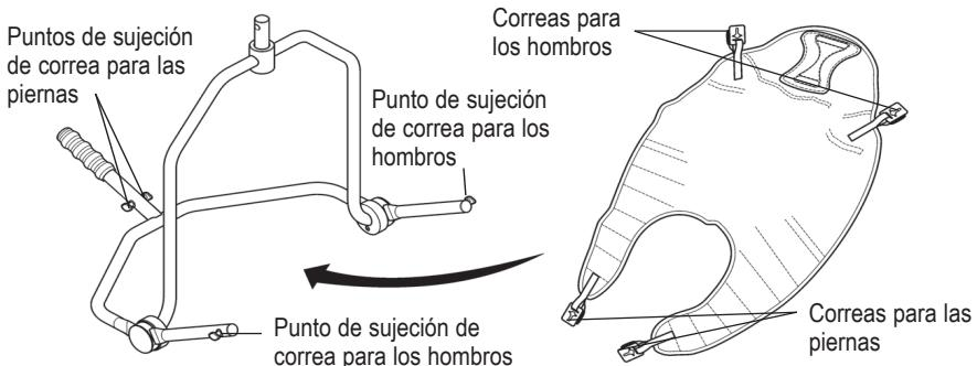
**Percha de 4 puntos:** ejemplo de la eslinga de la percha de 4 puntos con sistema de clip de seguridad.
