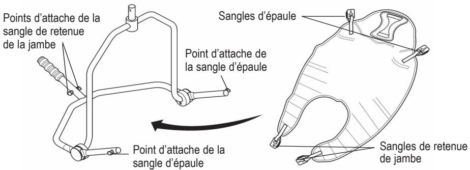
**Châssis à 4-points de fixation:** Exemple d'une courroie pour châssis à 4-points dotée d'attachments sécuritaires.
