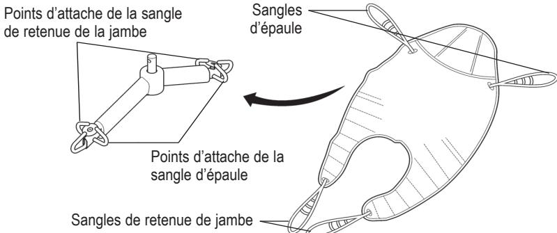
**Barre d'écartement à 6-points:** Exemple d'une courroie pour barre d'écartement à six points munie d'attaches en boucle.
