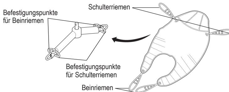
**Sechspunkt-Spreizbügel:** Beispiel für Sechspunkt-Spreizbügelmurt mit Befestigung durch Schleifen.
