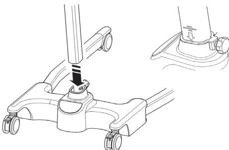
3. Apriete el conjunto de mástil con el dispositivo de bloqueo del mástil, que está situado en la parte delantera del chasis.
