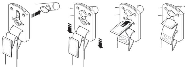
**Sistema de fijación de eslinga Securi3.** Ejemplo de instalación.
