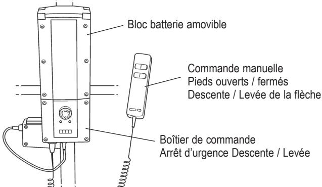
Lorsque le bloc d'alimentation doit être rechargé, retirez-le du lève-personne et branchez-le sur le chargeur autonome.
