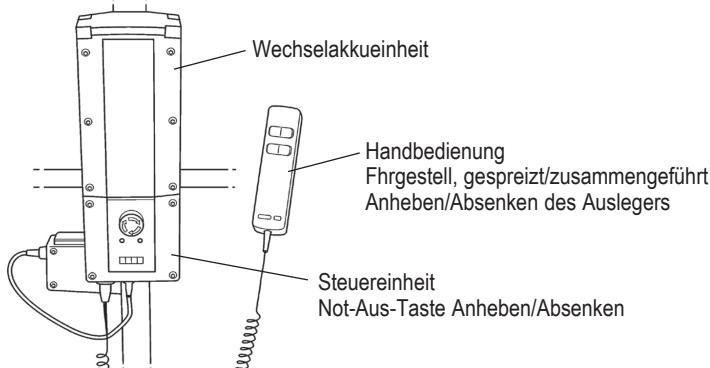
Wenn die Akkueinheit aufgeladen werden muss, wird sie vom Lifter entfernt und an eine externe Ladeeinheit angeschlossen.
